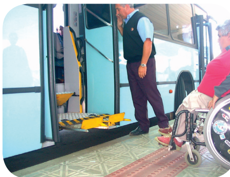
O ônibus com plataforma elevatória permite às pessoas em cadeira de rodas ou com problemas de locomoção o acesso ao transporte público. Fonte: Acervo autoras.
