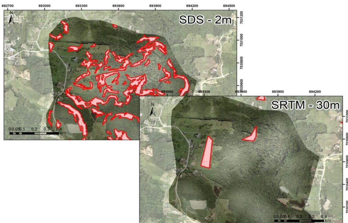
Imagem 9: Influência da escala de trabalho sobre a densidade de áreas de perigo identificadas. À esquerda produto gerado a partir de MDE com resolução de 2m e à direita a partir de MDE com resolução de 30 m (CPRM, 2018).
